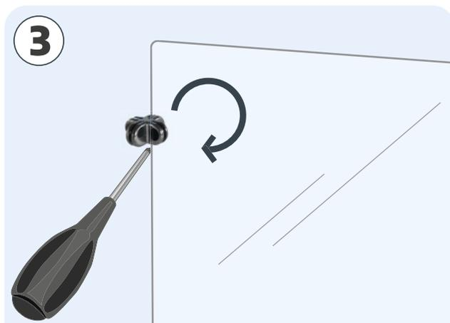
3 Nehmen Sie zunächst eine der vier Wände und bringen Sie die beiden Verbinderstücke an der 55 cm hohen Seite der Wand an. Mit einem Schraubenzieher fixieren Sie den Verbinder an der Spuckwand.
