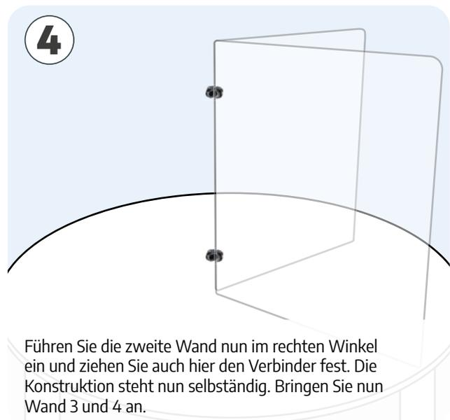
4 Führen Sie die zweite Wand nun im rechten Winkel ein und ziehen Sie auch hier den Verbinder fest. Die Konstruktion steht nun selbständig. Bringen Sie nun Wand 3 und 4 an.
